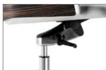
**SYNCHRO OSCILO** : mécanisme avec carcasse en aluminium poli. Mouvement d'inclinaison du dossier et rotation de l'assise selon un rapport 2:1. Inclinaison maximale de 20 degrés. 5 positions de fixation. Système anti-retour. Réglage de la tension ou dureté de l'inclinaison du dossier. Réglage de l'inclinaison et de la hauteur avec des poignées latérales.
